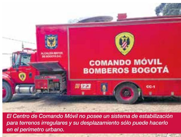
El Centro de Comando Móvil no posee un sistema de estabilización para terrenos irregulares y su desplazamiento sólo puede hacerlo en el perímetro urbano.
